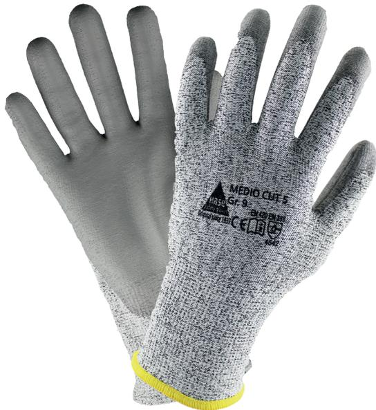
Schnittfester Montagehandschuh Level 5, Material: Hybridgarn aus HPPE und Glasfaser, Handinnenfläche und Fingerkuppen mit einer Polyurethan-Beschichtung, Foam-Struktur für guten Griff, Handrücken unbeschichtet, Länge: 22-27cm
